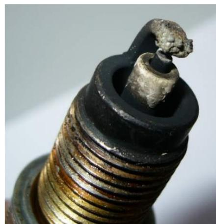
Ein falsches Anzugsmoment bei der Zündkerzenmontage kann zum Bruch der Kerzen, aber wegen falscher Flächenpressungen im Gewinde- und Anlagebereich auch zu einer veränderten Wärmeabfuhr und zu irregulären Temperaturen führen.
