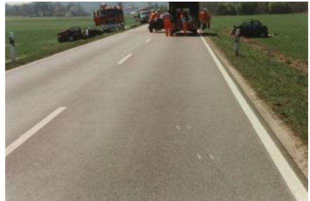
ABS-Spuren vor Erreichen des Kollisionspunkts, Driftspuren des entgegenkommenden PKWs
