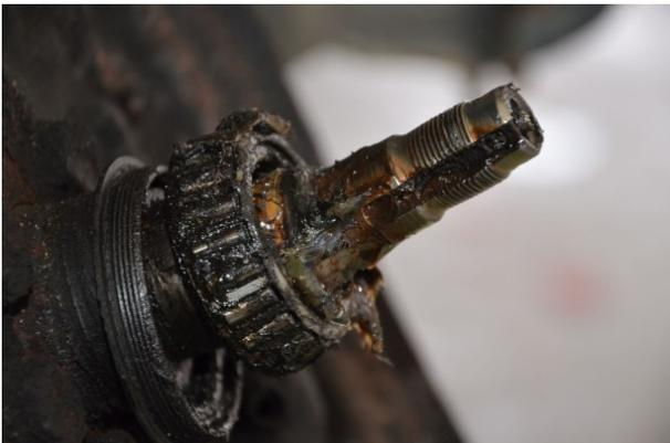
Achsstummel von hinten oben gesehen, Gewinde und Nut weitgehend unbeschädigt.
