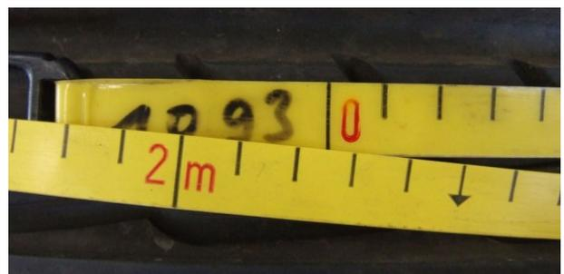
Der Abrollumfang der montierten Reifen unterschied sich um 9 cm bzw. ca 4,5 %
