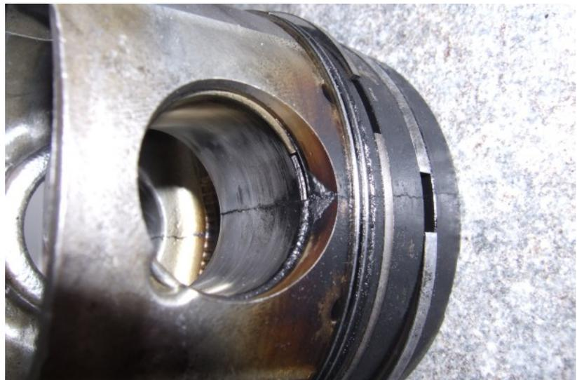
Das Bruchbild entlang des Risses zeigt einen spontanen Gewaltbruch und deutet auf eine mechanische Überlastung hin.
