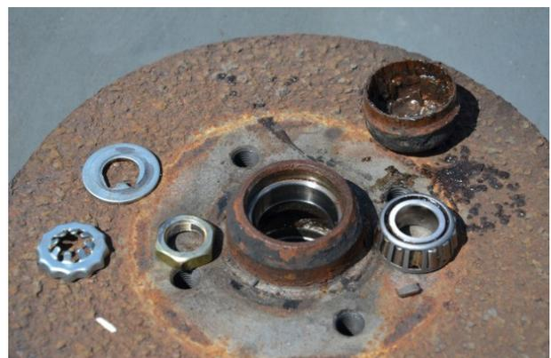
Bremstrommel (von außen) mit Radlager und Befestigungselementen.
