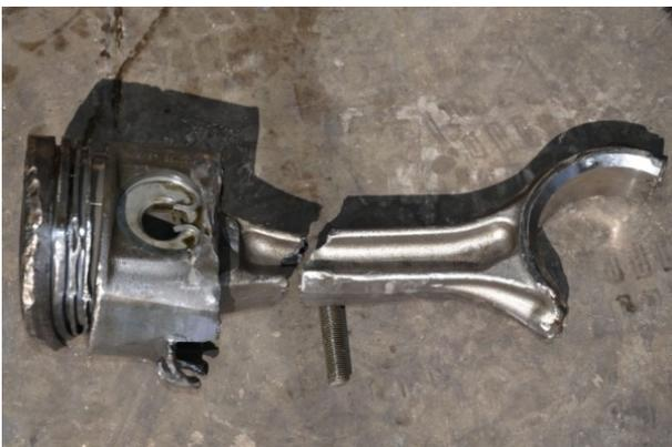
Schaden an Kolben u. Pleuel des 5. Zylinders
