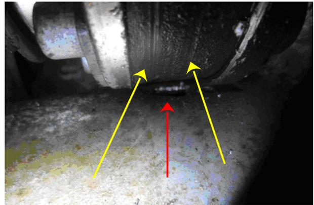
Loch im Getriebegehäuse von hinten unten gesehen. Auffällig sind die Längsriefen im Antriebswellenflansch und die Tatsache, dass sich das Loch unterhalb der engsten Stelle zwischen Getriebe- wand und Flansch befand.
