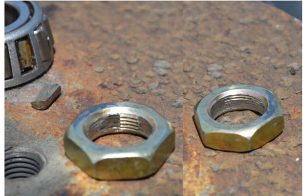
Das Gewinde der Befestigungsmutter ist im Bereich der Achsstummelnut weitgehend unbeschädigt, im übrigen Bereich aber komplett ausgerissen.
