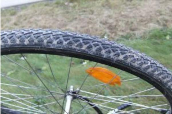
Seitlicher Abrieb am Fahrradvorderreifen
