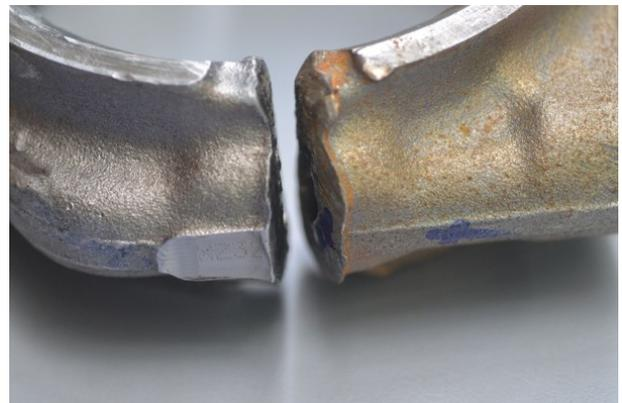
Das Schadenbild an den Passstellen, die Bruchbilder der Pleuelschrauben, die Gewindeabdrücke in den Bohrungen des Pleueldeckels und die Quetschdeformationen (linkes Bild links) dokumentieren die Relativbewegungen von Pleuel und Deckel nach dem Bruch der rechten und unmittelbar vor dem Bruch der linken Pleuelschraube (linkes Bild).
