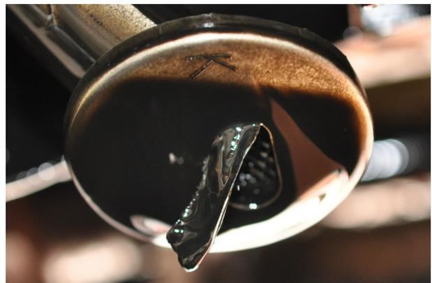
Turboladerschaden durch Verstopfung des Ölfilter-Ansaugbereichs mit Silikonstückchen, auf denen noch die Abdrücke des Zylinderkopfs erkennbar waren.
