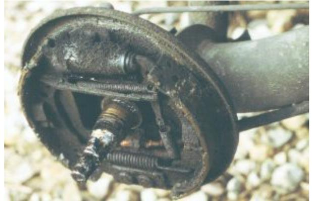
Ursache: undichter Radbremszylinder
