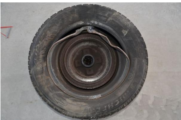
Abseits vom Endstand des PKWs aufgefundenes Rad mit Bremstrommel (von innen) und deutlichen Deformationen an der inneren Felge.
