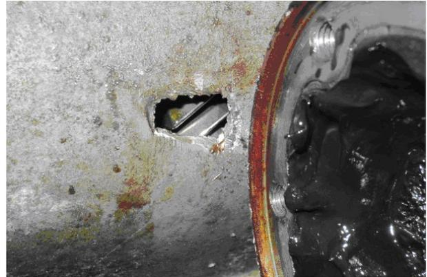
Bei ausgebautem Getriebe fallen auf: die Form des Lochs, die Struktur der Bruchstellen und die rötlichen (rost-farbenen) Antragungen um das Loch herum.
