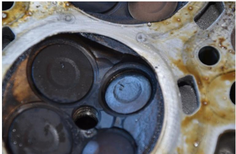
Nach der Demontage des Zylinderkopfs werden erhebliche, thermisch bedingte Beschädigungen der (nicht gehärteten) Ventilsitze und der Ventile selbst festgestellt.
