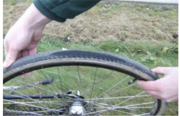
starker Abrieb am Fahrradhinterreifen
