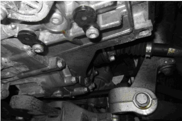
Getriebe und linke Antriebswelle eines VW Golf von vorne unten gesehen. Das Getriebe hatte nach einer Zahnriemenreparatur Öl verloren.
