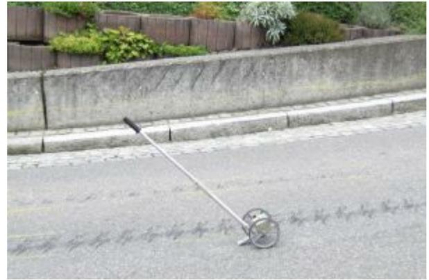
Driftspuren und Mauerkontakt durch Reifen
