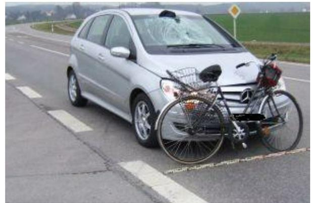
Korrespondierende Spuren auf der Fahrbahn → und vor Ort rekonstruierte Kollisionsstellung
